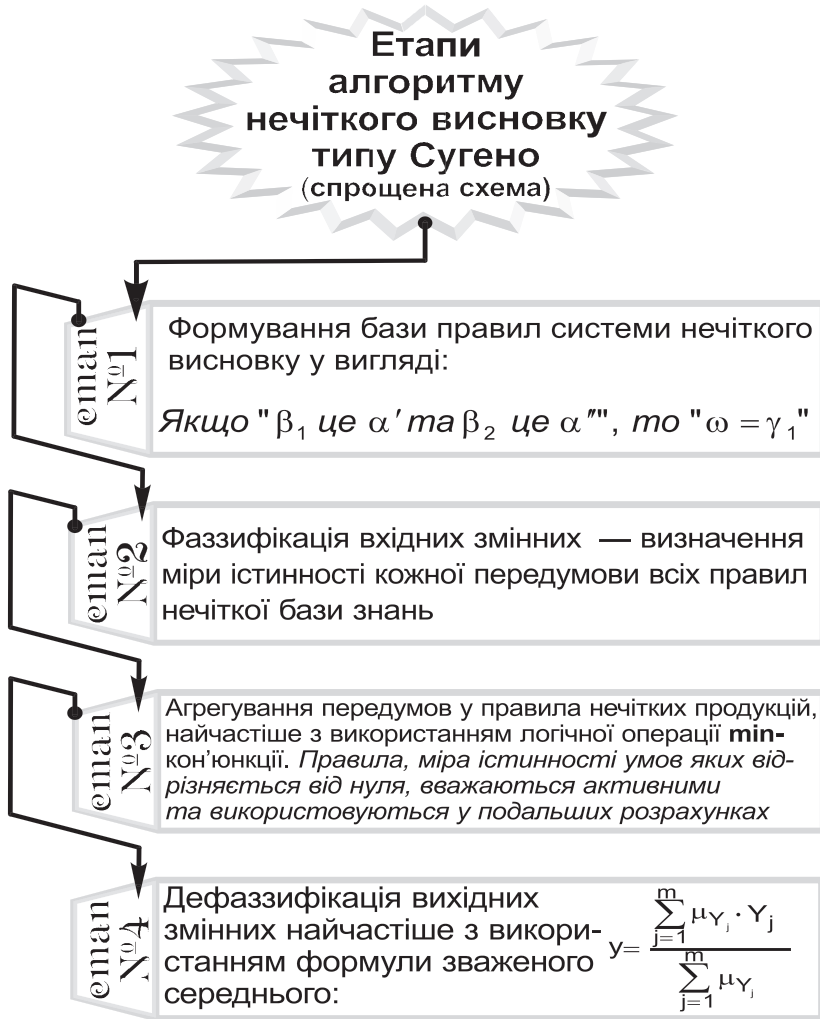
Рис. 6.10. Алгоритм виконання нечіткого логічного висновку типу Сугено за спрощеною схемою (вихідна змінна задається у вигляді констант)
