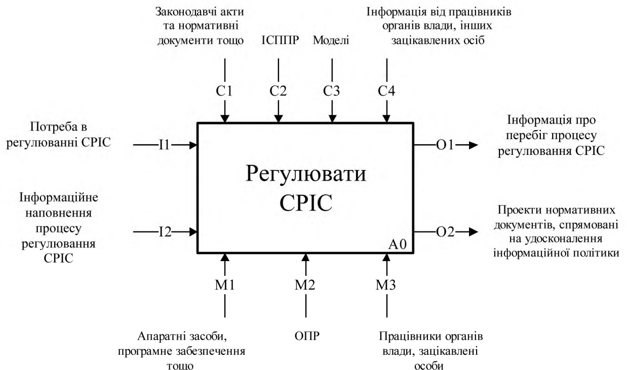
Рис. 5.22. Контекстна діаграма моделі IDEF0 регулювання СРІС
